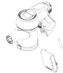
3. นำตัวเครื่องดูดฝุ่น จากข้อ 2 ประกอบเข้ากับ ด้ามโลหะพร้อมหัวแปรงดูดฝุ่น จากข้อ 1 ประกอบเข้าด้วยกัน
